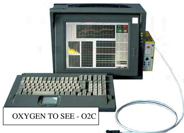
Die Methode wird bezeichnet als Gewebe-Photo-Spektrometrie (Tissue Photo Spectrometry = TPS) und besteht aus einer Kombination von Weißlichtspektrometrie und Laser-Doppler-Spektroskopie.
